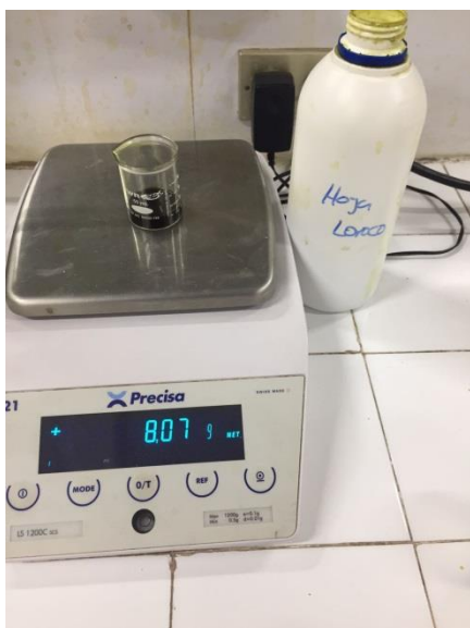
Figura 1. Determinación de densidad del extracto de hoja de loroco.
