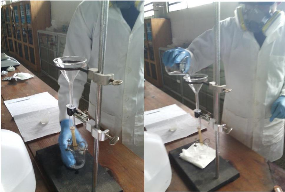
1 Preparación de columnas cromatográficas
