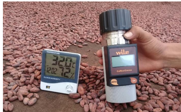
Figura 8. Medición de temperatura y humedad durante el proceso de secado.
