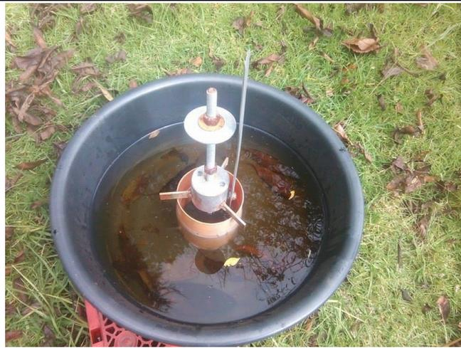
Fotografía 6: Tanque de evaporación
