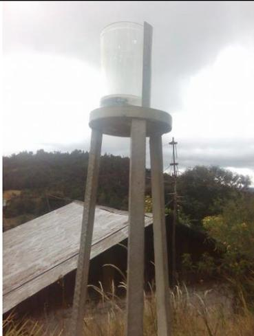
Fotografía 5: Pluviómetro
