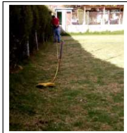
Realización de sondeo eléctrico vertical
