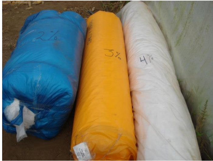
Fotografía 15. Tela no tejida de polipropileno con estabilizadores de rayos ultravioleta 2%, 3% y 4%.
