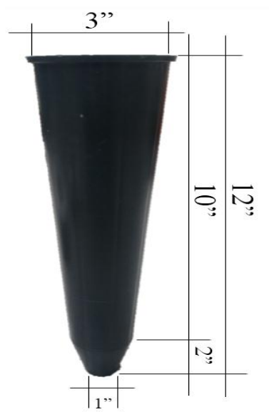
Figura 9. Medidas del tubete utilizado en la investigación
